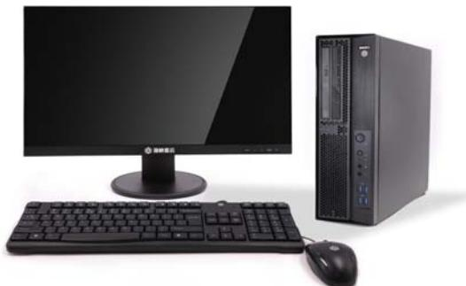
海峡星云GH3000是基于新一代强劲性能的 C86 3250 处理器开发的全新工作站产品。采用全新设计的高主频 CPU, 最大提供 8 核处理能力, 主频 2.8GHz, 是目前提供单线程工作能力最强的国产计算平台。
